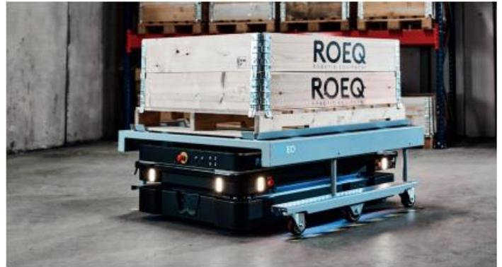
Le module de chariot ROEQ TMS-C1500 associée au ROEQ S-Cart1500W est capable de gérer différents types et tailles de marchandises : chariots, palettes, charges volumineuses.
