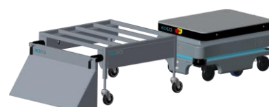
Etape 3 : Le chariot reste lié à la station, le MiR repart pour une autre mission
