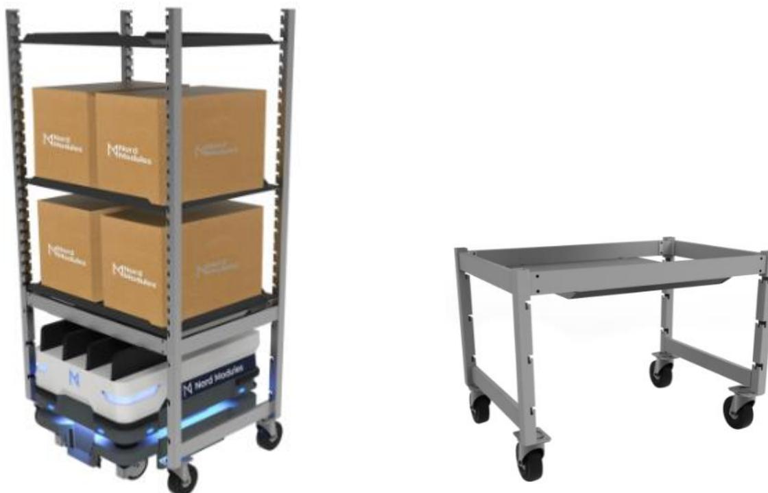
Le chariot de transport d'étagère SC200-480 fusionne avec le Quick Mover QM220. Installé sur le robot mobile MiR250 il peut recevoir ou livrer des objets placés sur le chariot d'étagère n'importe où sur le site de production. Possibilité jusqu'à 4 étagères
