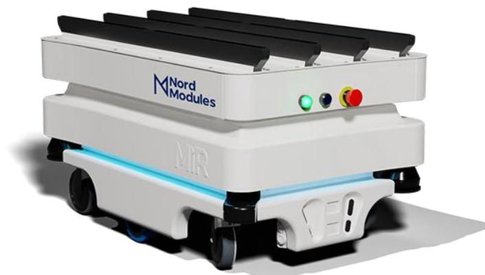
Ce top module est capable de transporter des marchandises avec le chariot à étagère SC200-532-01. Le module est monté sur le robot mobile et fonctionne grâce à un mécanisme de levage intégré au module.
