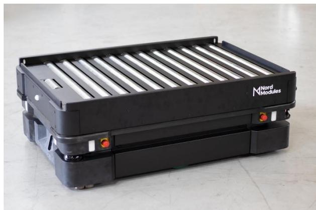
Le convoyeur PM800 de Nord Modules permet aux robots MiR600 et MiR1350 de ramasser et livrer des palettes en les transportant vers des lignes de production ou des stations d'emballage, favorisant l'organisation de la logistique.
