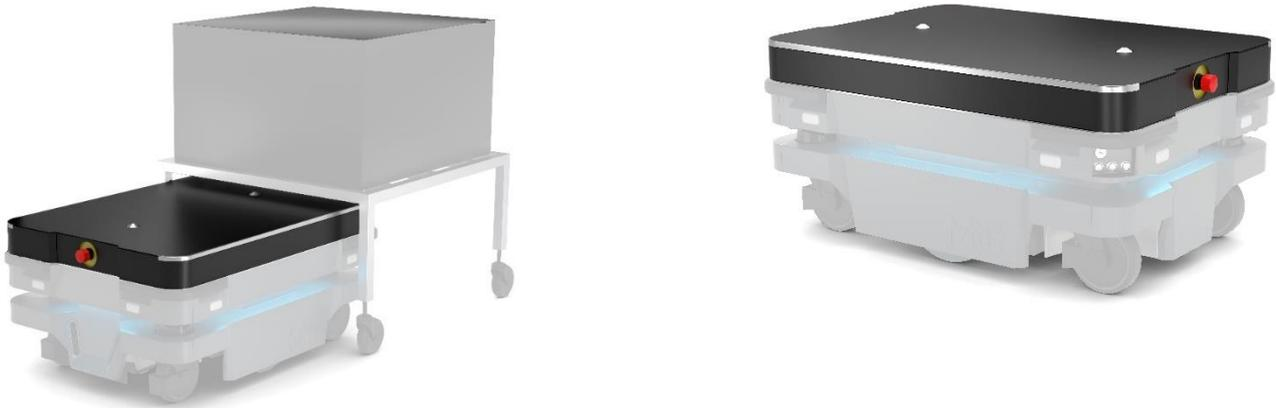
Le MiR Shelf Carrier, combiné au MiR250, est un dispositif d'ancrage qui permet de verrouiller et de déplacer des étagères jusqu'à 300 kg.
