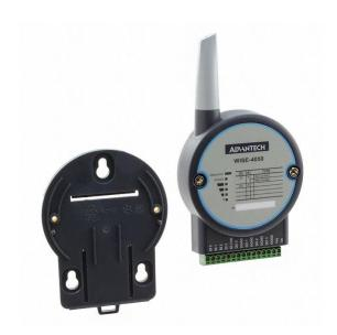
Le module permet à votre robot de commander des organes extérieurs, tels que des portes... Le module permet de gérer 4 sorties TOR (contacts secs) et 4 entrées TOR et est alimenté en 24 VCC. Il peut déclencher une porte ou un convoyeur, allumer un voyant, détecter l'état d'un bouton poussoir ou bien d'un capteur. Ce module existe en version Wifi et Lan.
