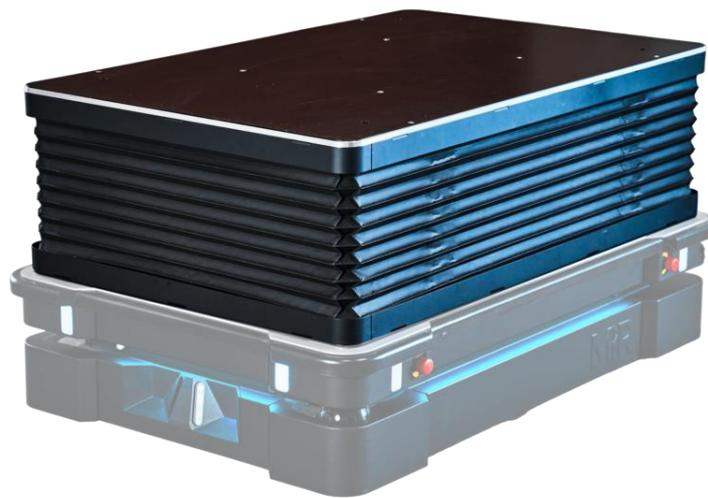
Le TML1000 peut ramasser et livrer des marchandises de différentes hauteurs. L'élévateur n'a pas besoin de revenir à sa position la plus basse pour le transport afin de réduire le temps de fonctionnement. Il fonctionne avec des rayonnages à palettes, des stations de ramassage fixes avec des rouleaux / rouleaux mobiles. Il est équipé de trous de montage pour accessoires personnalisés (par ex. Plaques de fourche).
