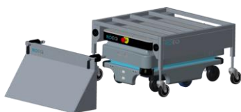
Etape 1 : Le MiR s'approche de la station
