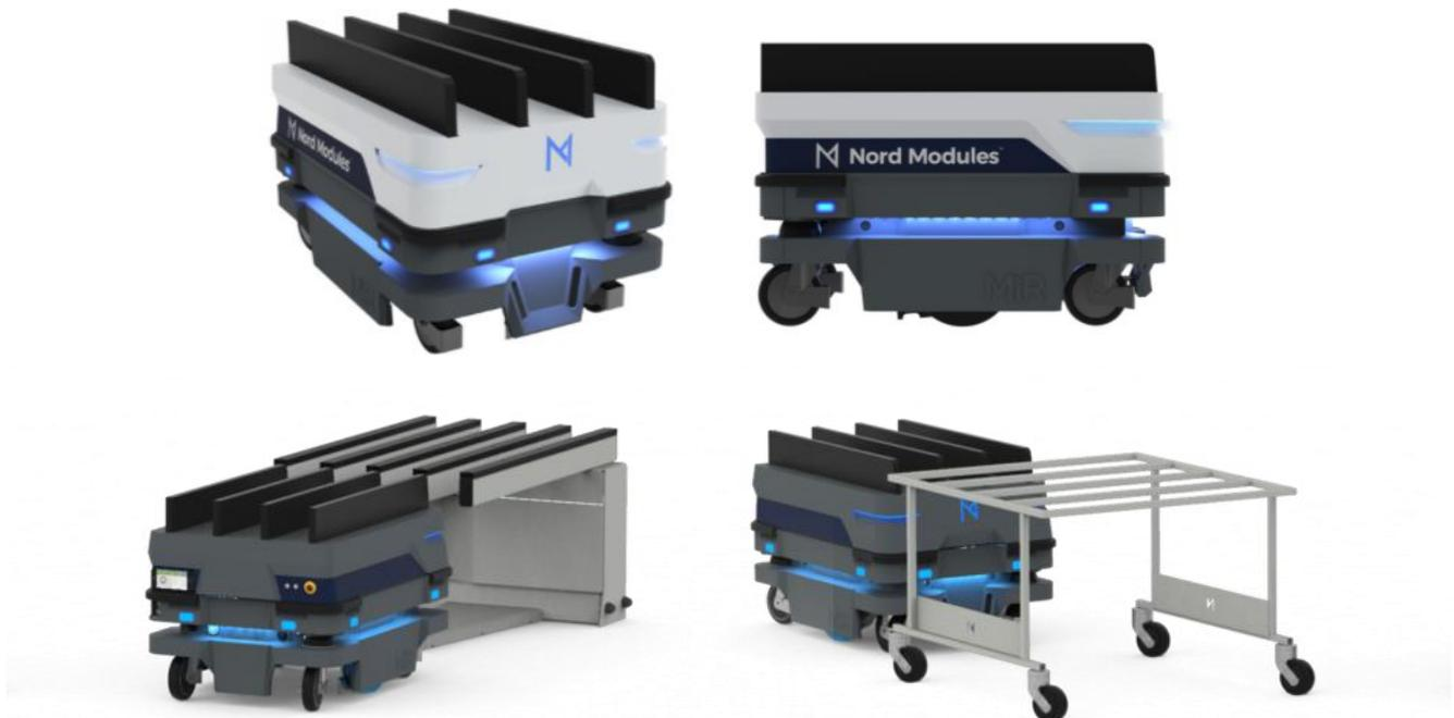
Le QM180 est un top module placé sur le dessus des robots mobiles MiR100 ou le MiR250 et fonctionne par un mécanisme de levage intégré dans le module. Pour recevoir ou livrer un objet, le QM180 doit être complété par le système Wheel Gate ou le Solid Gate, connectant ainsi le robot mobile avec vos lignes de production et/ou vos systèmes de stockage. Sa fonction est d'assurer un point de prise/dépose dans votre atelier. Il peut également ramasser le chariot d'étagère SC400.
