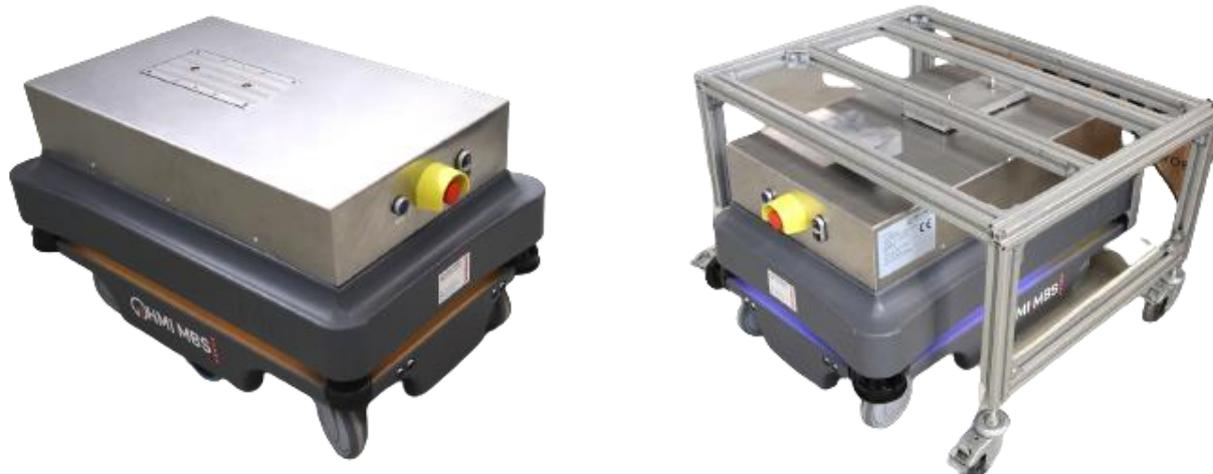
Le module HM Anchor est un système d'ancrage ou d'accroche permettant d'entraîner des chariots ou des étagères en venant se placer dessous et en se solidarissant à l'aide de 3 doigts.
