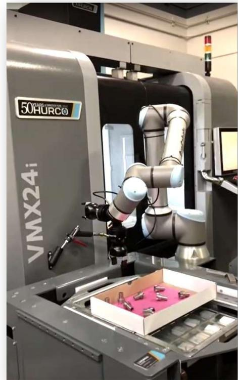
Easy Door est un système automatique et flexible d'ouverture de porte conçu pour une variété d'applications dans l'industrie d'usinage CNC.
