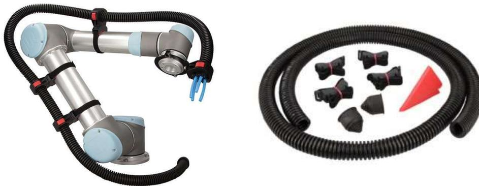
Le kit de fixation FHS-SH-Set est utilisé pour placer les câbles sur les cobots Universal Robots sans les abîmer et sans gêner les mouvements du robot. Le système de fixation et la bande Velcro permettent une fixation sûre et antidérapante. La gaine en polypropylène est dotée d'une fente longitudinale afin de faciliter le tirage des câbles préassemblés.
