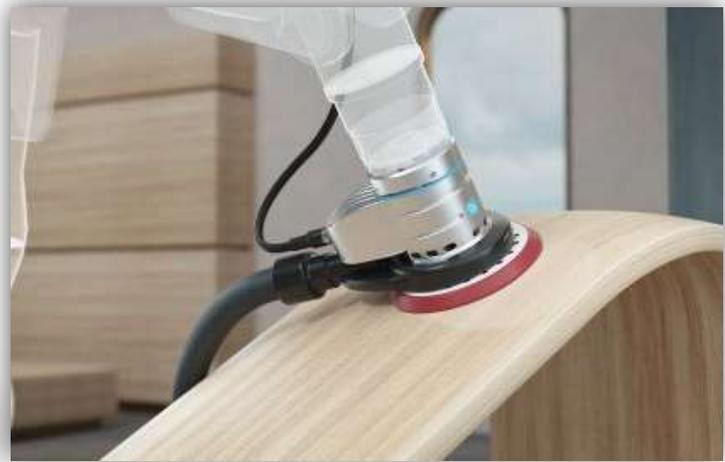
L'outil Sander d'OnRobot est une ponceuse électrique puissante fonctionnant sans air comprimé. Il a été spécialement conçu pour les applications collaboratives de nombreux domaines tels que : l'industrie du bois, l'automobile, l'aéronautique, la peinture, la tôlerie industrielle... La ponceuse OnRobot vous accompagne lors de vos opérations de finition, de nettoyage de soudure, ou encore d'adoucissage de rayure.
