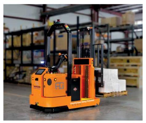
Le gerbeur MAX-N est un chariot élévateur à contrepoids automatique qui peut choisir et placer automatiquement des palettes au niveau du sol, des ponts de remorque, des convoyeurs ou des râteliers jusqu'à 1,5 mètre de haut.
