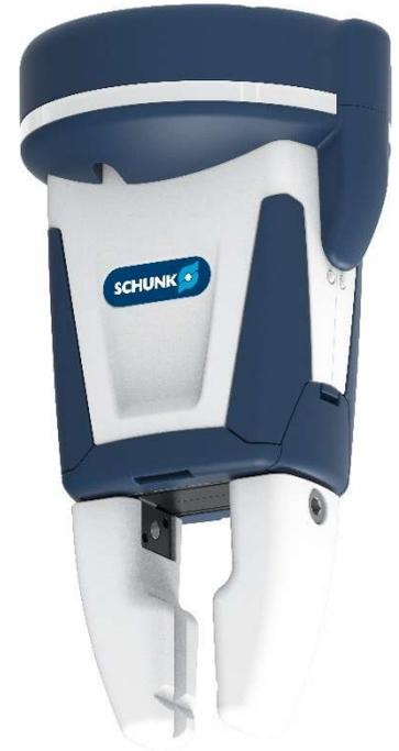
Ce préhenseur électrique à deux doigts\* à mouvements parallèles est contrôlable facilement à travers les Entrées/Sorties TOR du robot UR. Son montage se fait directement sur la bride du robot et son raccordement sur le connecteur E/S de l'axe 6.
