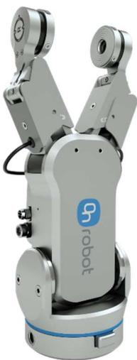
La pince RG2-FT dispose de capteur F/T au bout des doigts, capables de détecter le risque de glissement avant qu'il ne se produise.
