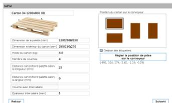
Définir les paramètres du plan de palettisation tel que les dimensions de la palette et du carton, les numéros des couches nécessitant un intercalaire, la position de prise du robot ...
