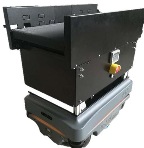
Le convoyeur à bandes HM Cab est réglable mécaniquement en hauteur pour s'adapter à votre configuration.
