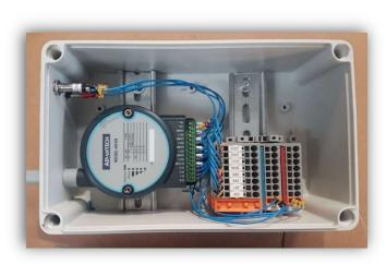
Ce boitier vous permet d'utiliser 4 entrées et 4 sorties TOR (Tout Ou Rien) sur les robots MiR. Par exemple, le MiR pourra ensuite détecter l'ouverture d'une porte, allumer un gyrophare aux intersections, échanger des informations entre le robot MiR et le poste de chargement/déchargement du MiR.
