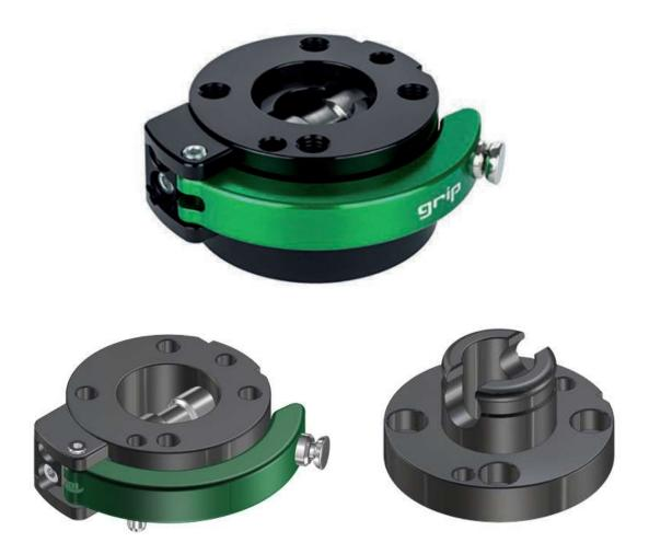
Le changeur d'outil rapide SHW063 permet à l'opérateur de changer l'effecteur du robot en fonction du besoin de préhension sans avoir besoin d'outils.
