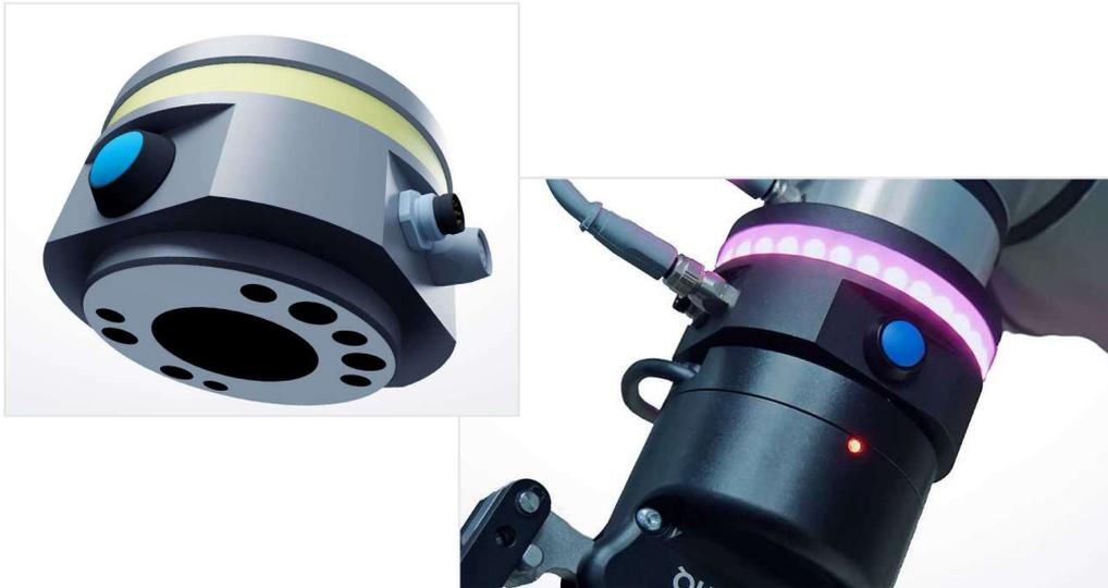
Le module YouRing, grâce à ses LED puissantes et son buzzer, permet d'alerter l'opérateur des mouvements du cobot.
