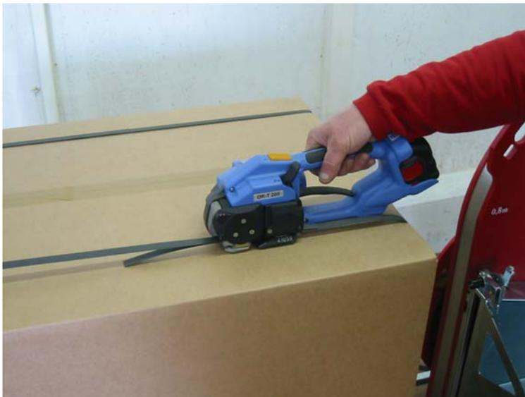
L'outil de fermeture coupe le bout du feillard qui dépasse et soude les deux extrémités
