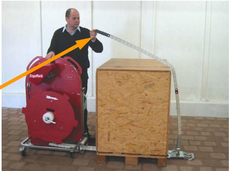
... et faites rentrer la chaîne de guidage en actionnant le joystick en arrière
