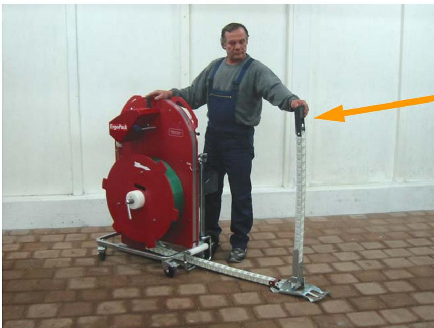
Maintenez l'extrémité de la chaîne de guidage avec la main gauche tout en continuant d'actionner le joystick en avant
