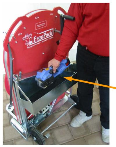
Placez l'appareil de fermeture dans compartiment de rangement.
