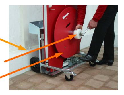
Réglez les 3 boulons sur le diamètre central de votre rouleau de feuillard. Un diamètre central de 406 mm a été réglé à l'usine.
