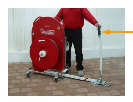
...et maintenez l'extrémité de la chaîne de guidage avec la main gauche.
