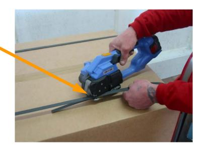
... et faites passer le feuillard dans l'appareil de fermeture.
