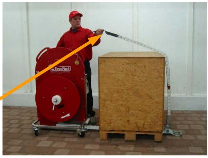
...et faites revenir en arrière la chaîne de guidage en tournant la manivelle dans le sens contraire des aiguilles d'une montre.
