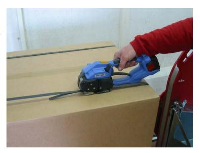
Après le serrage et la soudure du feuillard, l'appareil de fermeture coupe l'extrémité de feuillard dépassant.
