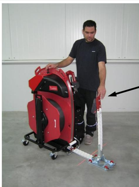
Maintenez l'extrémité de la chaîne de guidage avec la main gauche tout en continuant d'actionner le joystick en avant.
