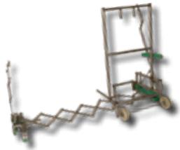
Premier prototype de cerclage basé sur un système à double ciseaux, similaire à une table de levage en ciseaux.
