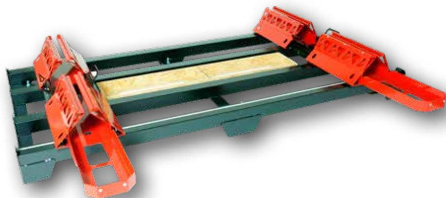
La station mobile de canaux de guidage est flexible et précise. Elle inclut les canaux de guidage. La distance entre les canaux de guidage peut être ajustée continuellement grâce au mètre intégré. Toujours adaptée à vos besoins, la station mobile de canaux de guidage est fabriquée selon vos exigences. Toute la station peut être déplacée à l'endroit où vous souhaitez cercler.
