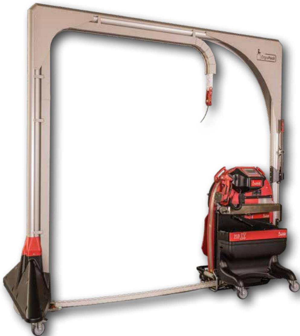
Cet accessoire réalisé sur mesure permet de cercler des palettes jusqu'à 3m de hauteur.
