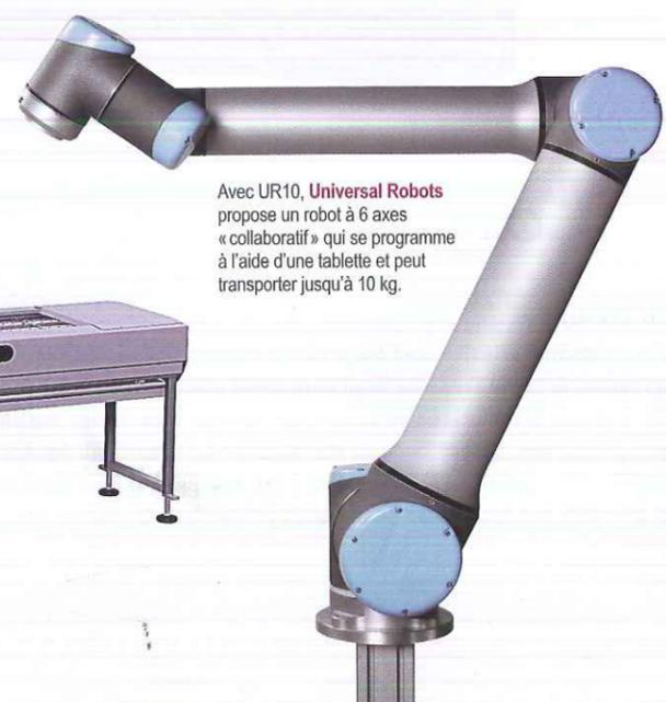
Avec UR10, Universal Robots propose un robot à 6 axes «collaboratif» qui se programme à l'aide d'une tablette et peut transporter jusqu'à 10 kg.
