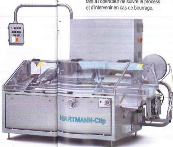
La clippeuse Hartmann dispose d'une large porte transparente relevable permettant à l'opérateur de suivre le process et d'intervenir en cas de bourrage.
